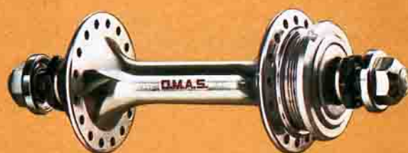
Art. 1100/P Mozzo posteriore pista battuta da mm. 120 fori flange n. 24-28-32-36 Filettatura \varnothing 35 \times 24 f. (a rich. \varnothing 34,7 \times 1 \varnothing 1,370 \times 24 Tpi BSC)
